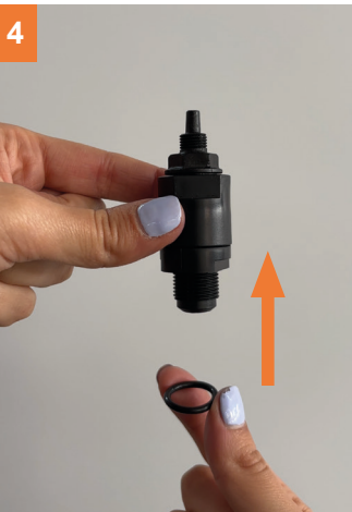
4 Coloque o anel de vedação (O-ring) na rosca do injetor.
