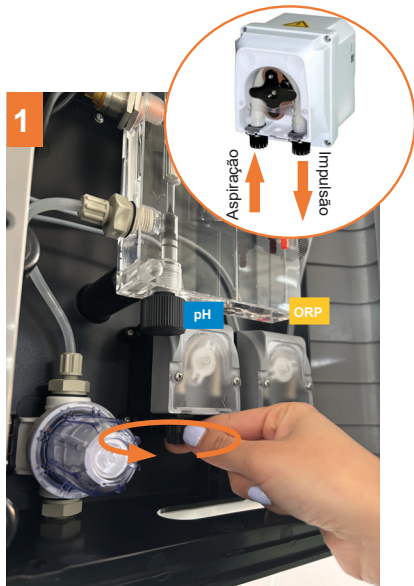
1 Desenroscar o encaixe de entrada (aspiração) da bomba peristáltica de pH (bomba esquerda)
