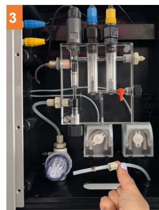
3 Nasadte konektor a svěrný kroužek na pevnou (bílou) trubku. Ujistěte se, že orientace dílů odpovídá fotografii. Část B je uvnitř části A.
