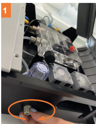
1 Odšroubujte konektor vstupního šroubení (připojení k předfiltru)
