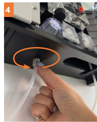
4 Zašroubujte konektor a zkontrolujte správné utažení trubky
