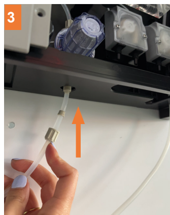
3 Vložte trubku do přívodního šroubení
