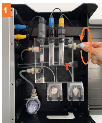
1 Odšroubujte konektor z výstupního hrdla
