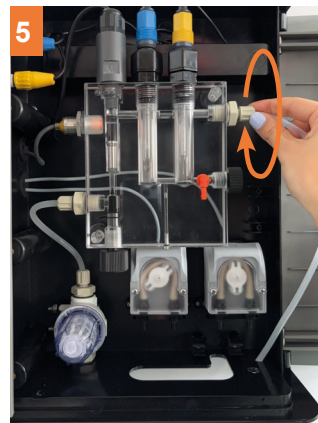
5 Visser le connecteur et vérifier que le tuyau est bien serré
