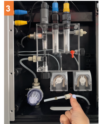
3 Insérer le connecteur dans le tuyau rigide (blanc, PE6X4). S'assurer que les deux pièces sont bien dans le sens indiqué sur la photo. La pièce B (butée) doit être à l'intérieur de la pièce A (raccord).
