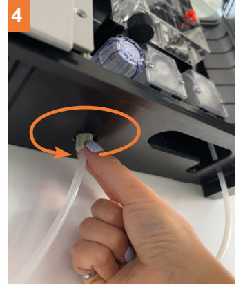
4 Visser le connecteur et vérifier que le tuyau est bien serré
