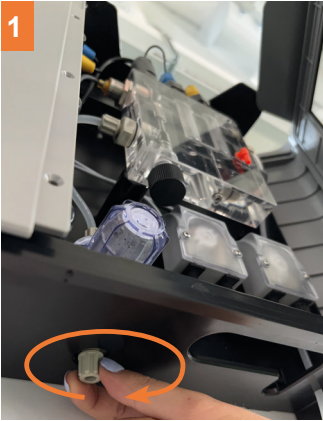
1 Dévisser le connecteur du raccord d'entrée (connexion au préfiltre)
