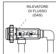
INSTALLAZIONE CONSENTITA TUTTI I MODELLI (Mod. 12/24/32 LS g/h con sensore di flusso)
