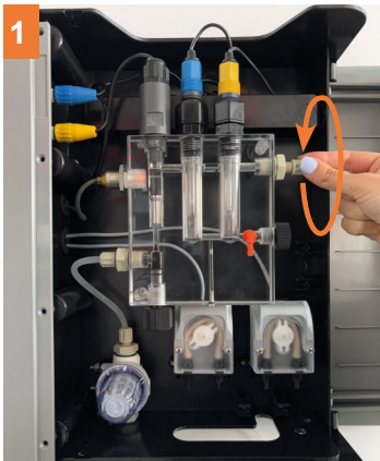
1 Desenroscar el racor de salida
