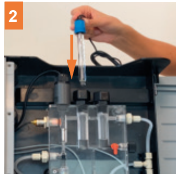
2 Introducir el sensor de pH (azul) en el alojamiento izquierdo del portasondas.
