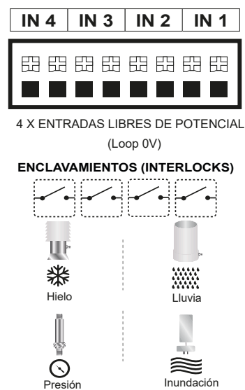
⑦ Enclavamientos (Interlocks)
