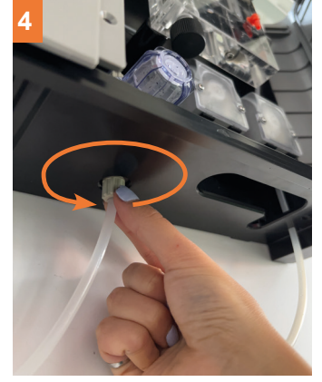
4 Enroscar el racor y comprobar el correcto apriete del tubo
