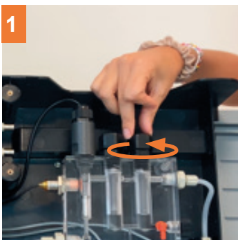
1 Desenroscar la tuerca del racor
