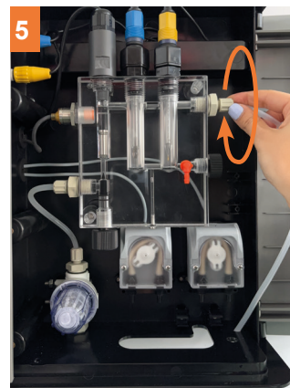
5 Enroscar el racor y comprobar el apriete correcto del tubo
