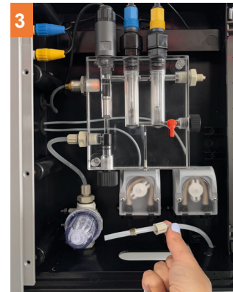
3 Introducir el racor y la férula en el tubo rígido (blanco). Asegurar que la orientación de las dos piezas sea la mostrada en la foto. La pieza B (férula) se encuentra adentro de la pieza A (racor).
