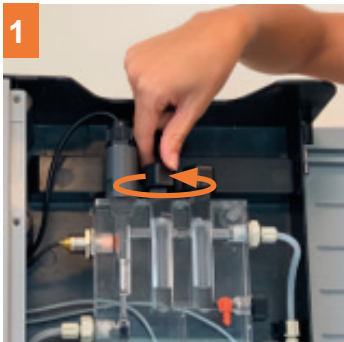
1 Desenroscar la tuerca del racor
