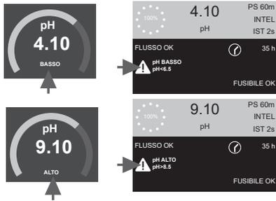
Se la misurazione del pH non rientra nei valori configurati, appaiono allarmi di livello basso e alto. Questi valori non sono modificabili.
