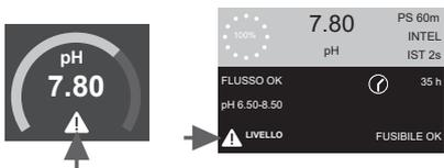
Il sensore di livello è un dispositivo elettronico che misura l'altezza del liquido in un serbatoio o altro contenitore. In genere, questo tipo di sensore funziona come un allarme, indicando l'allarme di basso livello.
