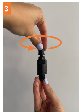
3 Schroef de connector los van de injector.
