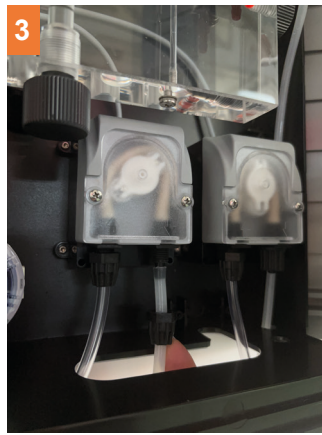
3 Duw de stijve slang in de uitlaat van de pomp.
