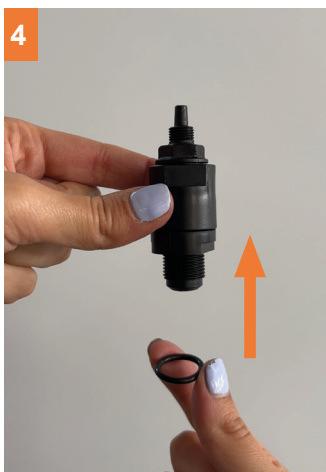
4 Plaats de O-ring op het schroefdraad van de injector.
