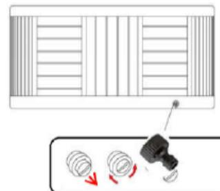
El desagüe se vuelve a cerrar enroscando nuevamente el tapón y empujando a continuación el empalme hacia el interior del spa.
