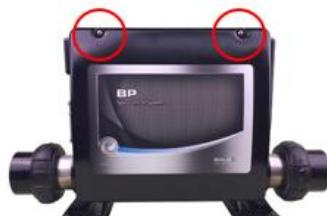
4) Pase el cable por los prensaestopas de la caja de control
