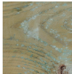
Retention of sterilization products Retención de productos de esterilización Rétention de produits déteuve Rückstände von Sterilisationsprodukten Ritenzione di prodotti per la sterilizzazione Vasthouden van impregneringsmiddelen Retenção de produtos de esterilização
