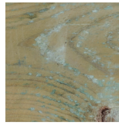
Retention of sterilization products Retención de productos de esterilización Rétention de produits détuve Rückstände von Sterilisationsprodukten Ritenzione di prodotti per la sterilizzazione Vasthouden van impregniemiddelen Retenção de produtos de esterilização
